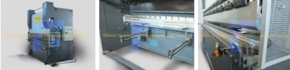
**Листогиб ИБ1430Б** оснащен современным гидравлическим оборудованием и используется в различных областях машиностроения, где производится гибка листового металлопроката.
