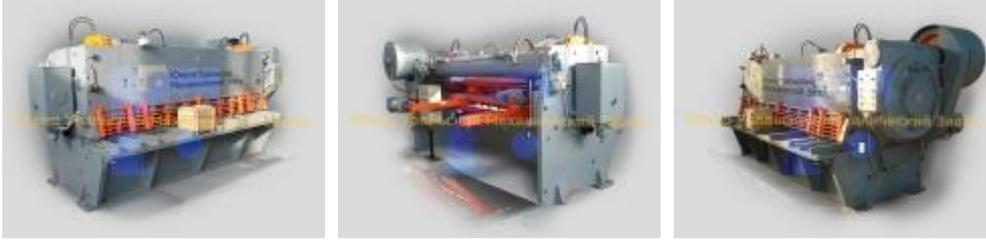
**Ножницы НА 3221 (12x3150)** используются для прямолинейной резки листовых и полосовых материалов, в заготовительных цехах машиностроительных предприятий.
